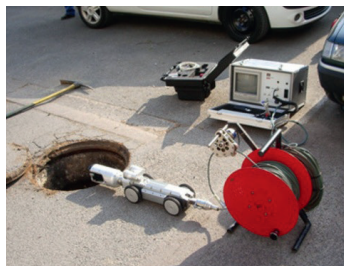
Matériel d'inspection des réseaux
