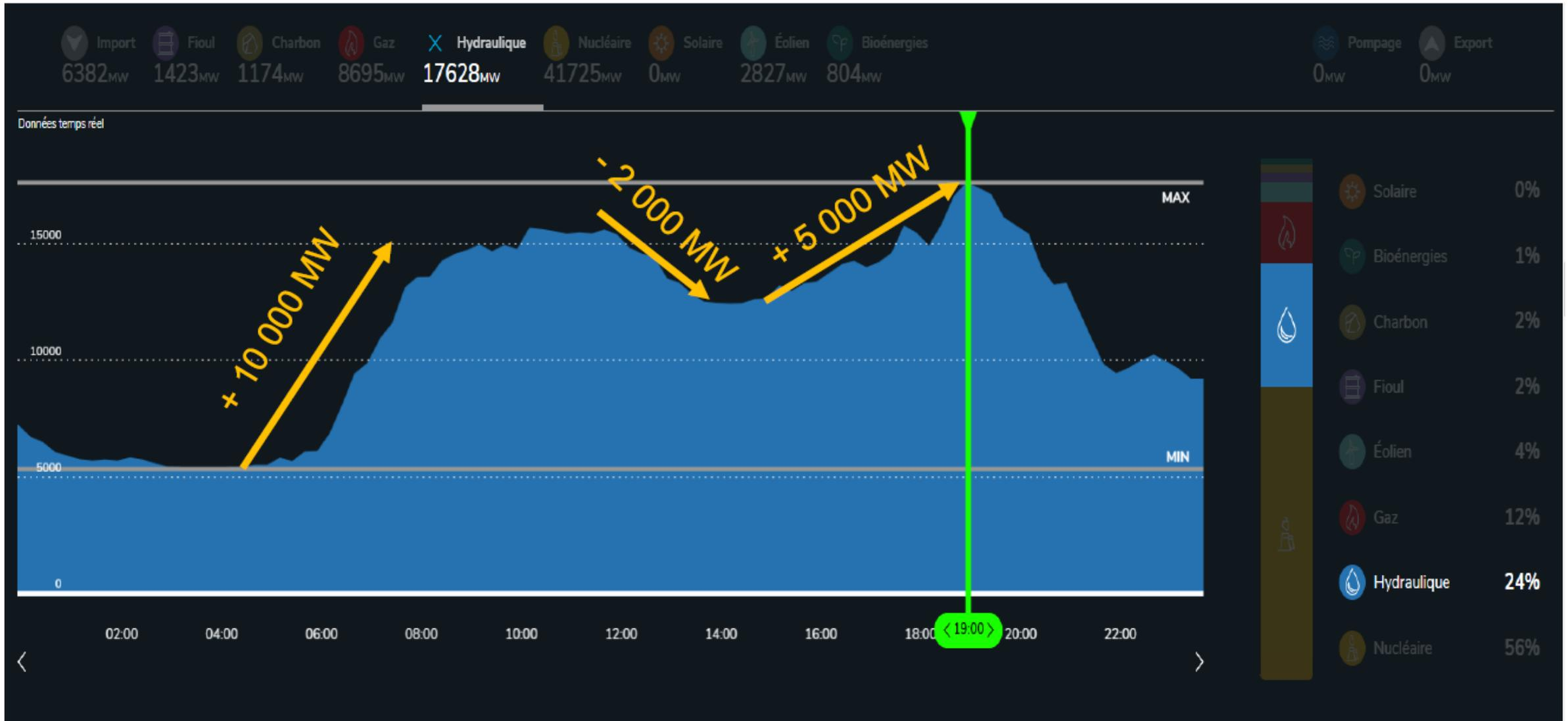
Des besoins de flexibilité x3 à l'horizon 2050 (+ 5000 MW pour l'hydroélectricité)
